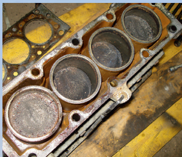
Nicht rund 80.000 Kilometer Laufleistung, sondern langer Stillstand hatte den Laufbuchsen des Alu-Vierzylinders zugesetzt
