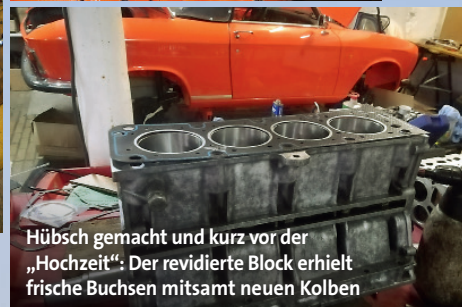
Nicht rund 80.000 Kilometer Laufleistung, sondern langer Stillstand hatte den Laufbuchsen des Alu-Vierzylinders zugesetzt
