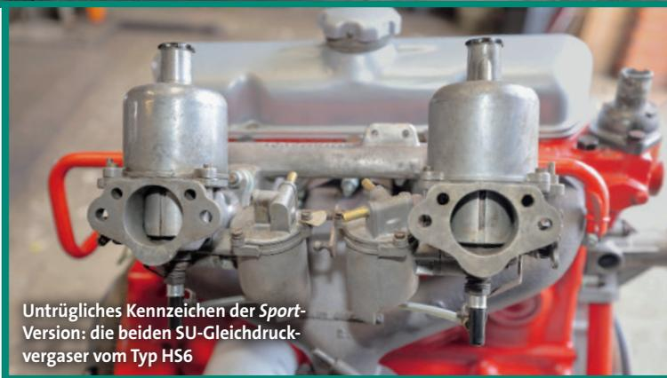
Untrügliches Kennzeichen der Sport-Version: die beiden SU-Gleichdruckvergasern vom Typ HS6
