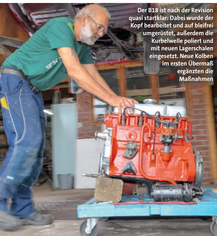
Der B18 ist nach der Revision quasi startklar. Dabei wurde der Kopf bearbeitet und auf bleifrei umgerüstet, außerdem die Kurbelwelle poliert und mit neuen Lagerschalen eingesetzt. Neue Kolben im ersten Übermaß ergänzten die Maßnahmen
