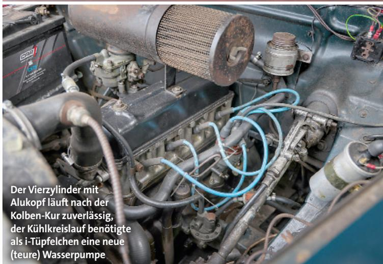
Der Vierzylinder mit Alukopf läuft nach der Kolben-Kur zuverlässig, der Kühlkreislauf benötigte als i-Tüpfelchen eine neue (teure) Wasserpumpe
